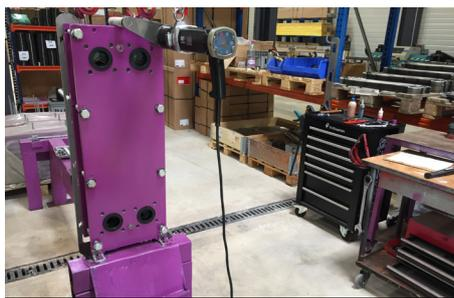
Un échangeur à plaques fait l'objet d'un serrage en croix pour assurer un bon alignement des plaques.
