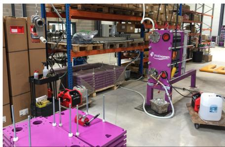
Les échangeurs à plaques sont testés en eau suivant le DESP à 1,43 fois la pression, avant leur emballage.
